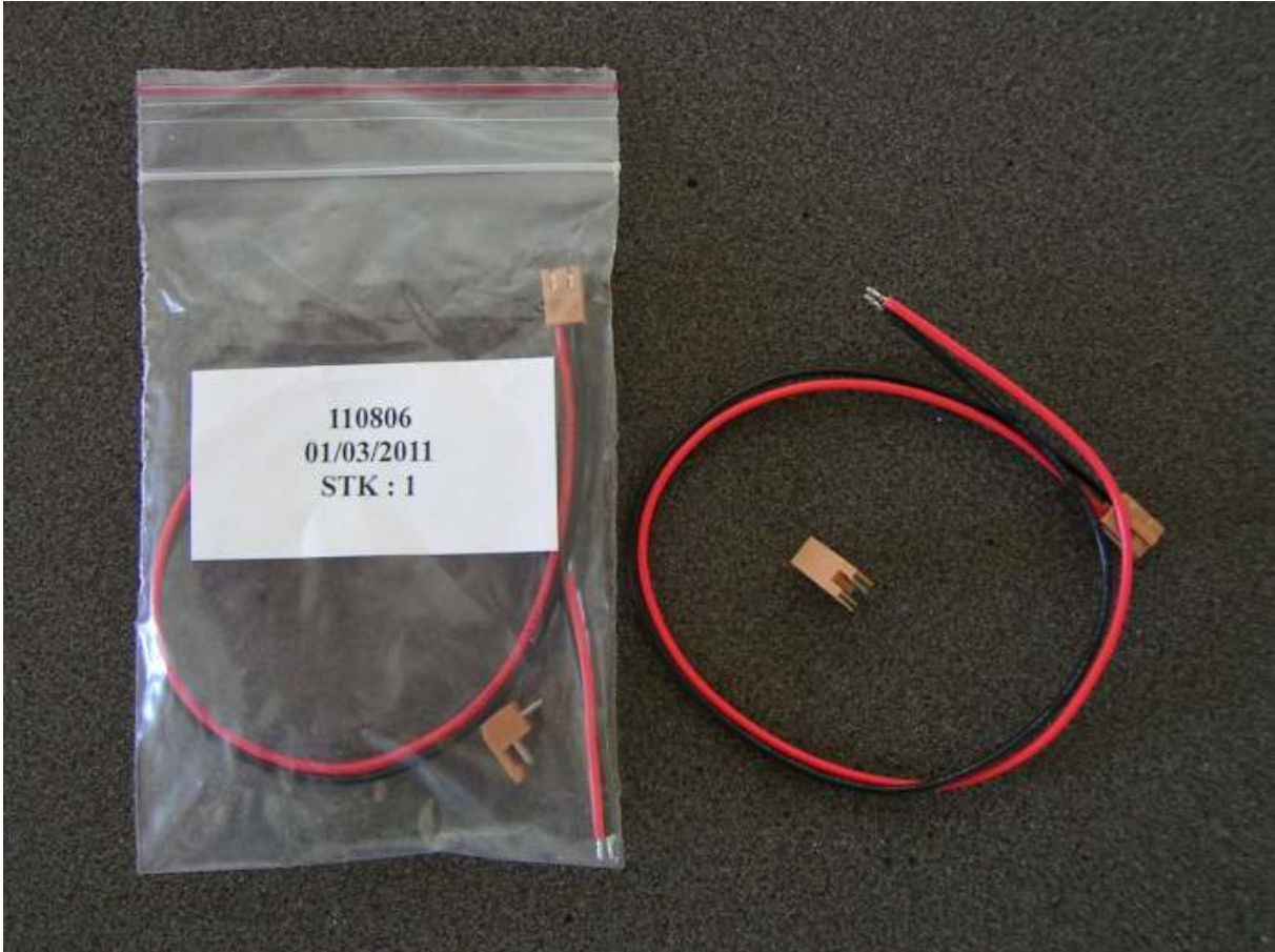
Bild/pic 19: Das Kabelset für LiPo-Monitor und den LED Ausgang - Connector set from Paul ( www.flyduino.com ) - used for LiPo-Monitor and LED-Stripes
