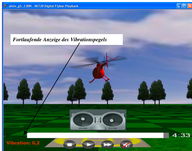
Logging Playback: mit Anzeige des allgemeinen Vibrationslevels, Fluglagen und Knüppelbewegungen
