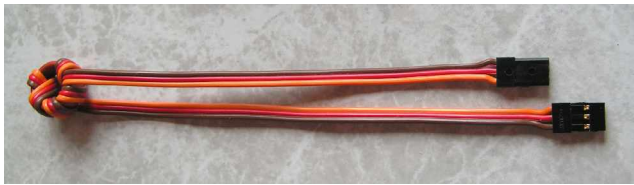
320mm langes BEC-Kabel mit Ringkern Entstörfilter
