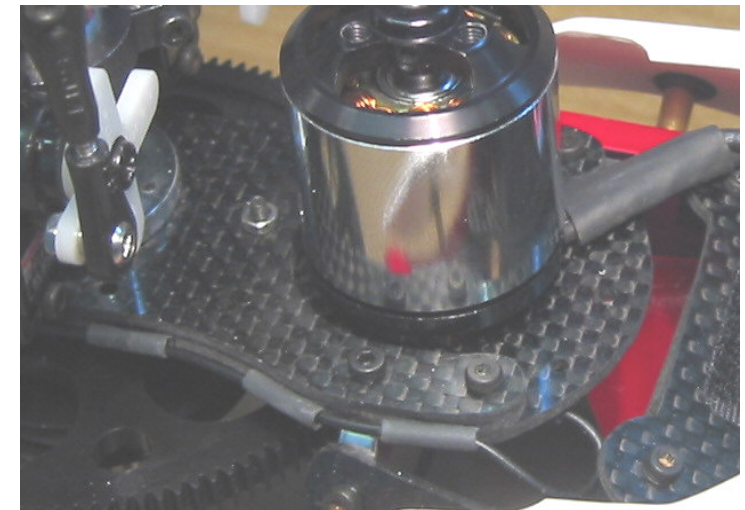
Kabelverlegung am Chassis
