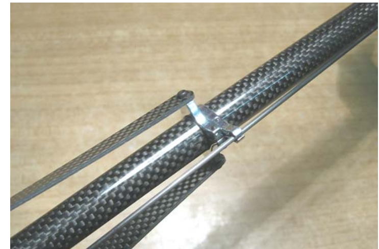
Einstellung der Gestängeführung
