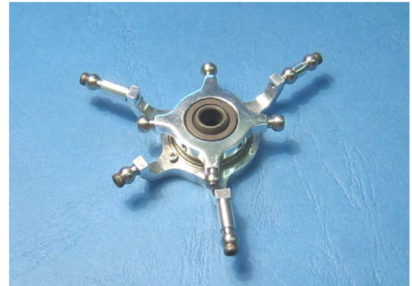
Taumelscheibe nach Kürzen der Schrauben ⇒
