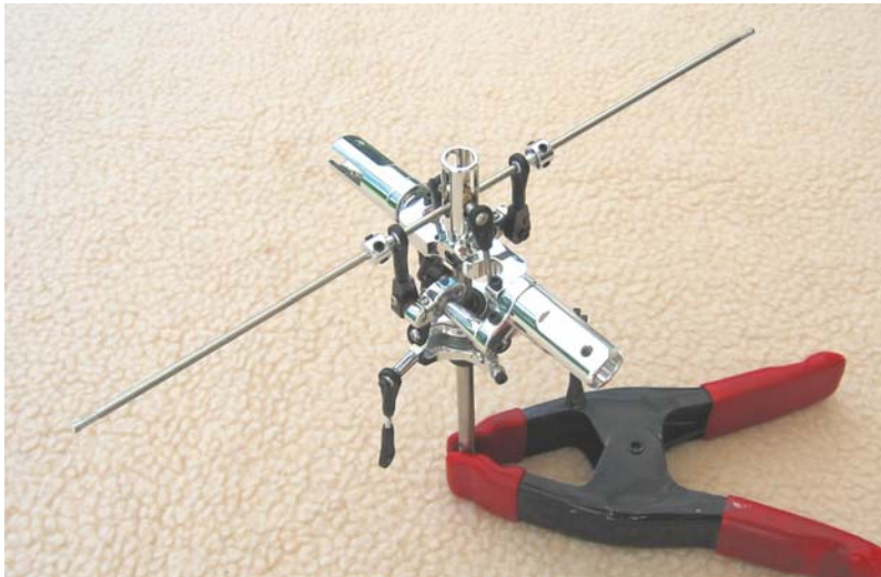
⇐ Vormontierter Rotorkopf incl. Pad- deleinheit
