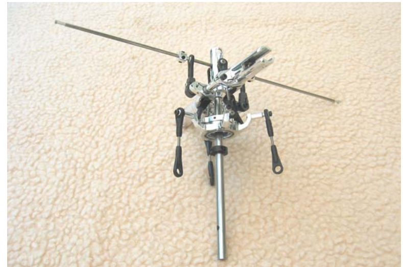
Ansicht des Rotorkopfes von unten ⇨
