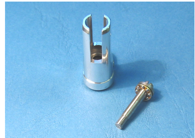
Hauptblatthalter mit Blattlagerachse
