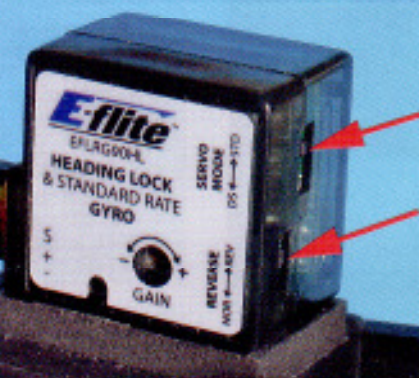
Der Umschalter für Digital- bzw. Standard-Servos befindet sich stirnseitig, wo auch noch ein weiterer kleiner Schalter zu finden ist, mit welchem sich die Wirkrichtung des Gyros umpolen lässt (s. Pfeile)
