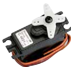
Ord.No. 3896 Fahrwerksservo 3 St. erforderlich
