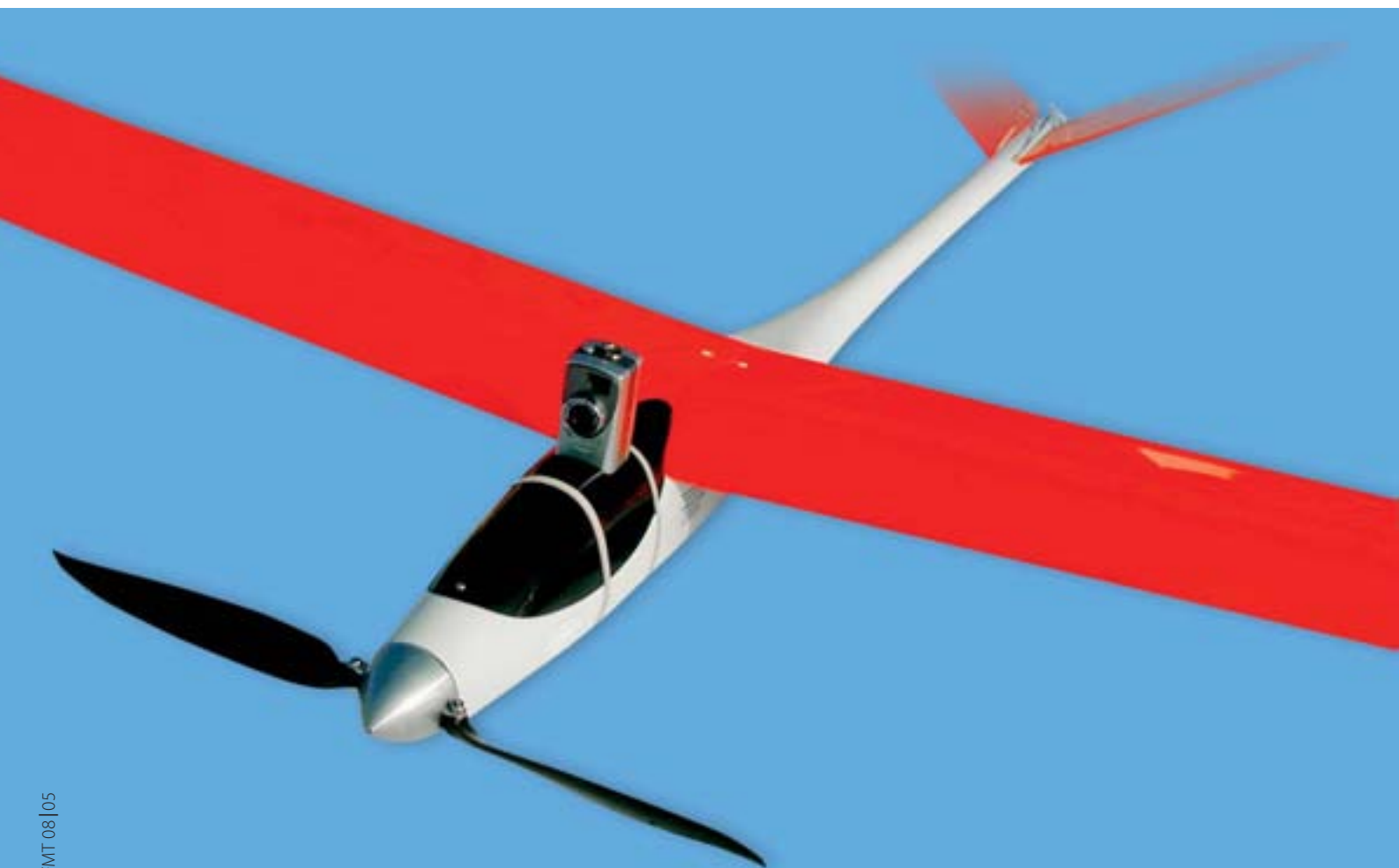
Kameraeinbau in der Kabinenhaube
