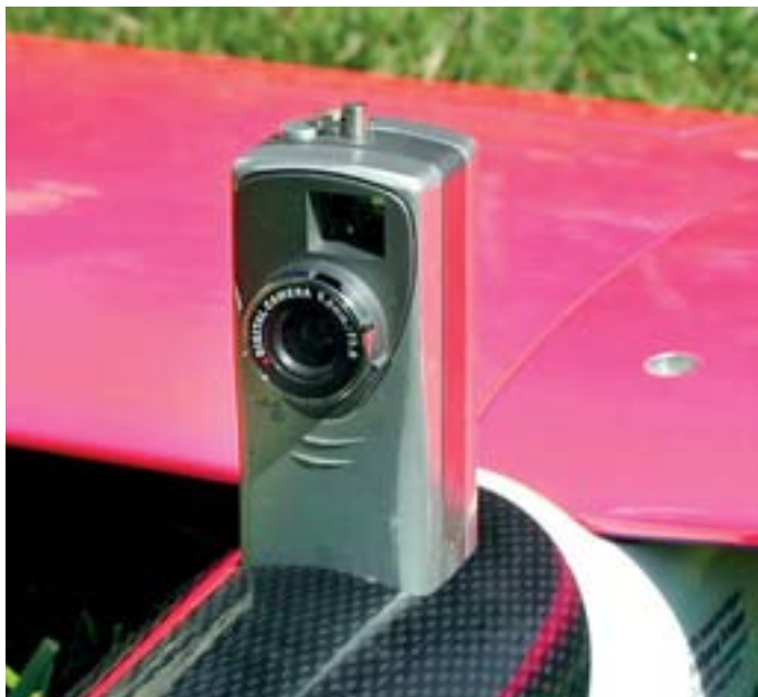
Kameraeinbau in der Kabinenhaube
